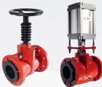
Typy PVG a PVEG Pinch prítlačné ventily Veľkosť 50 – 250 mm Tlak 6, 10 bar Ručné, pneumatické
