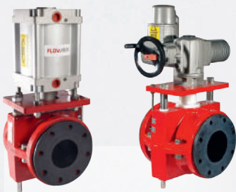
Typy PV a PVE Pinch prítlačné ventily Veľkosť 25 – 1000 mm Tlak 1, 6, 10, 16 bar, max. 100 bar Ručné, pneumatické, elektrické, hydraulické
