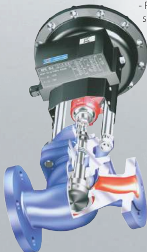
Fig. 472 - ARI STEVI - Regulačný ventil s elektropohonom ARI PREMIO Plus
