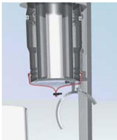
4 Folienträger lösen und entnehmen.
