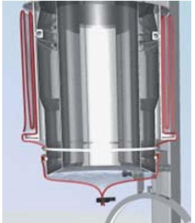
6 Folienende mit Spannring in oberer Nut fixieren.
