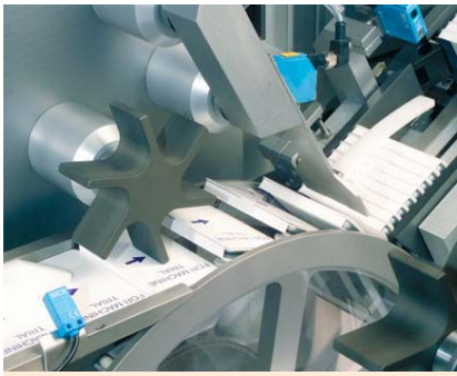
Aufstellen und Gruppieren der Walletpackungen im Magazinschacht
