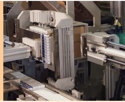
Aufrichten, Beladen und Verschieben von Versandkartons im Casepacker
