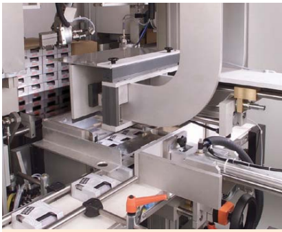
Einschieben der gestapelten Faltschachtel packungen über Oberläuferschieber
