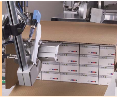
Einschub der Faltschachtelstapel in den aufgerichteten Versandkarton
