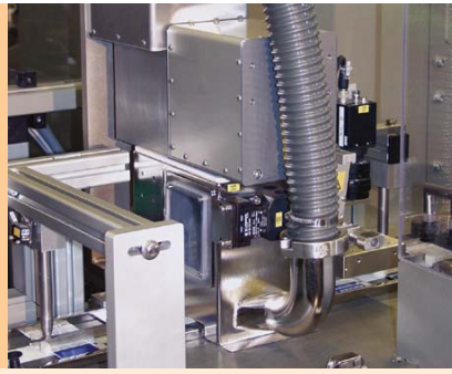
Lasercodierung von horizontal zugeführten Faltschachtelzuschnitten
