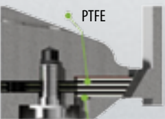
FKX 9000™ Kombinácia tesnení PTFE/Nerezová ocel' Teplota: -60°C do +260°C
