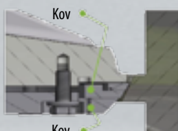
FKX 9000™ Kombinácia tesnení Kov/Kov Teplota: -60°C do +550°C
