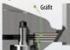
FKX 9000™ Kombinácia tesnení Gráfit/Nerezová ocel' Teplota: -60°C do +550°C
