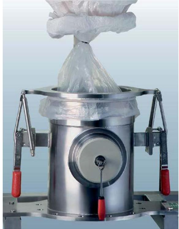
Für die Entleerung von Gebinde ohne Inliner (z.B. Container) wird ein Adapter mit Schutzfolien-schlauch an dem Gebinde angebracht.
