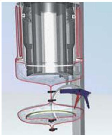
8 Restfolie und Spannring abziehen. Zwei mal dicht übereinander verschließen.
