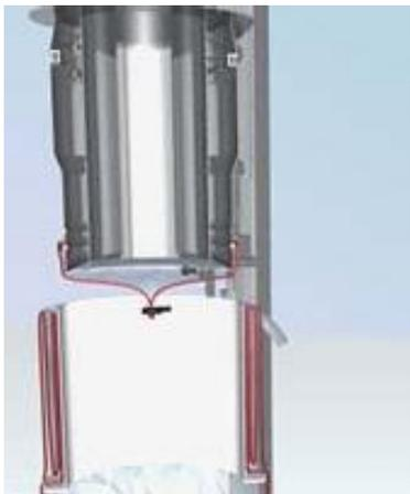
5 Folienträger mit Folienpaket bestücken.
