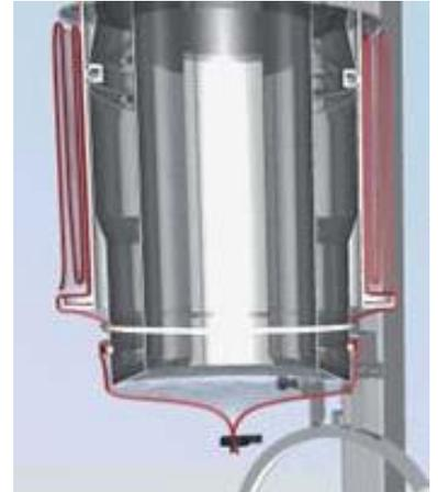
6 Folienende mit Spannring in oberer Nut fixieren.
