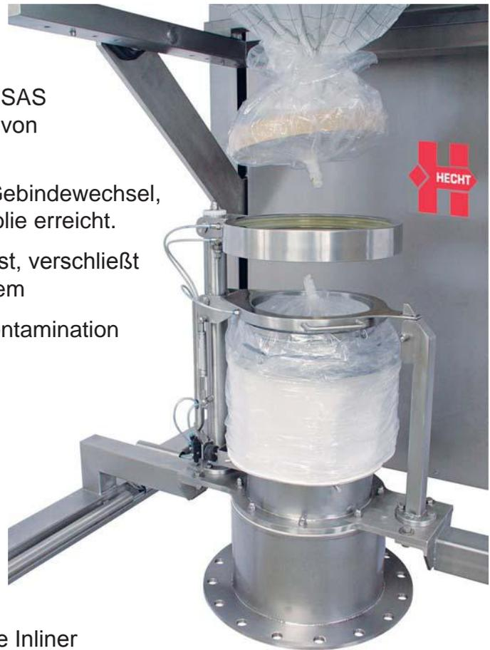
Für die Entleerung von Gebinde ohne Inliner (z.B. Container) wird ein Adapter mit Schutzfolien-schlauch an dem Gebinde angebracht.
