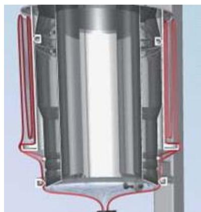
Befüllkopf in Grundposition
